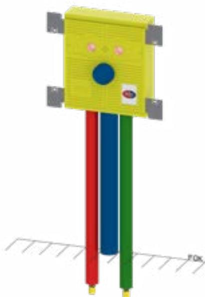
Boxtechnik wie Standard, jedoch mit im Isolierkörper eingebundener Rohrisolierung.
