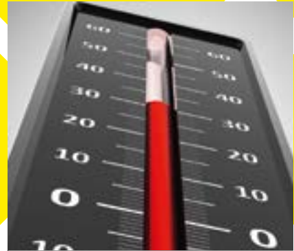
Temperaturen zwischen 25 und 55° C müssen in Hausleitungen unbedingt vermieden werden.
