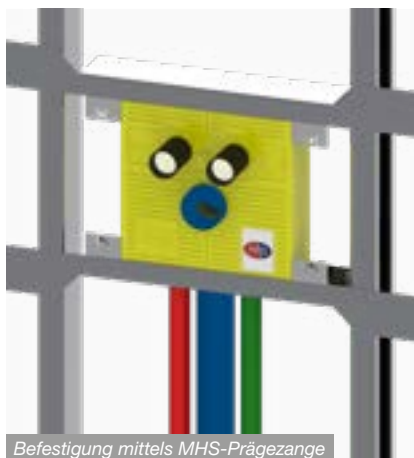
Befestigung mittels MHS-Prägezange
