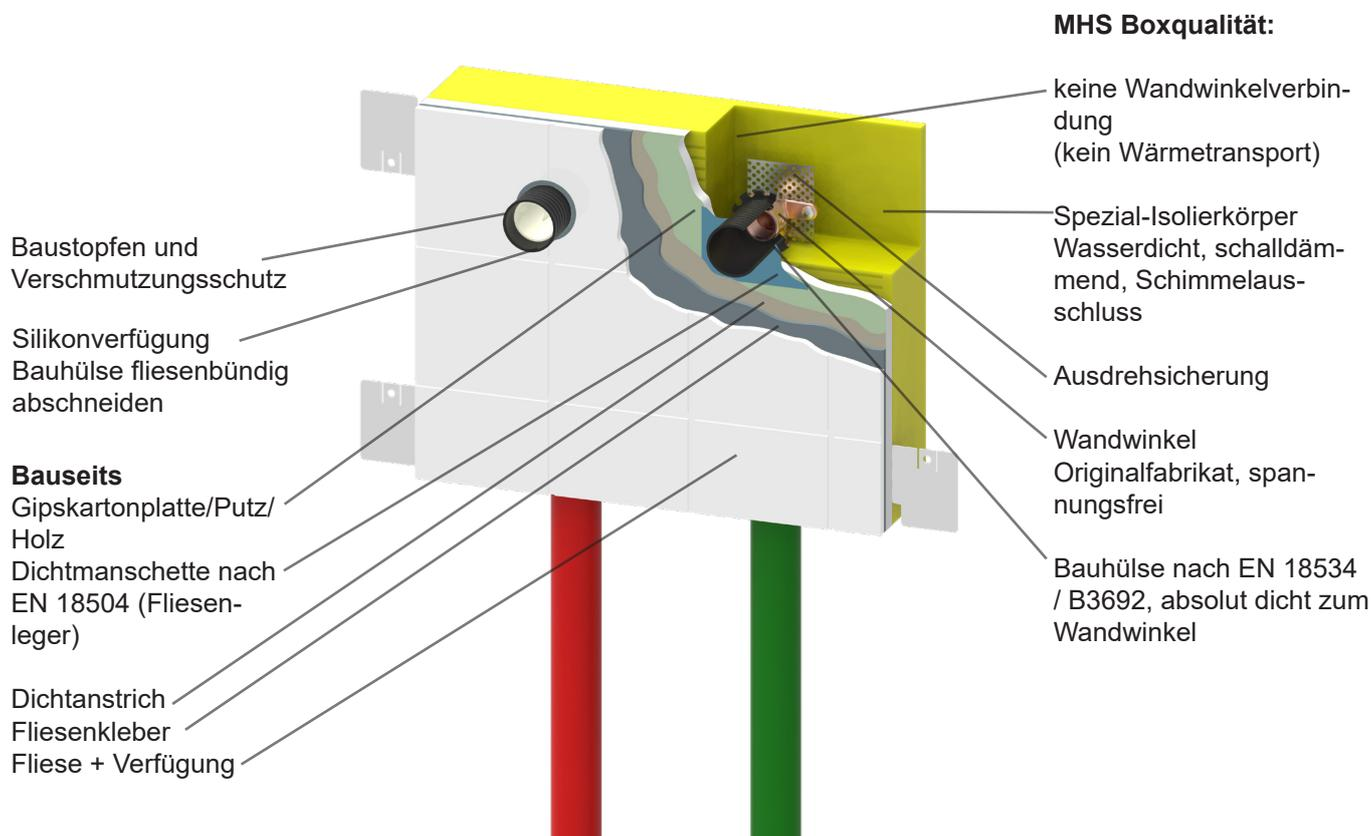
Die Bauschutzhülse verhindert den Wassereintritt in den Baukörper im Auslassverlängerungsbereich und ist im Isolierkörper absolut dicht eingearbeitet. Der vorstehende Teil kann im Zuge der Armaturenkomplettierung fliesenbündig gekürzt werden.
